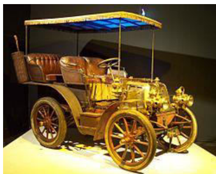
Vehiculul Panhard & Levassor , model 1899, unde forma caroseriei amintește de cea a trăsurilor
